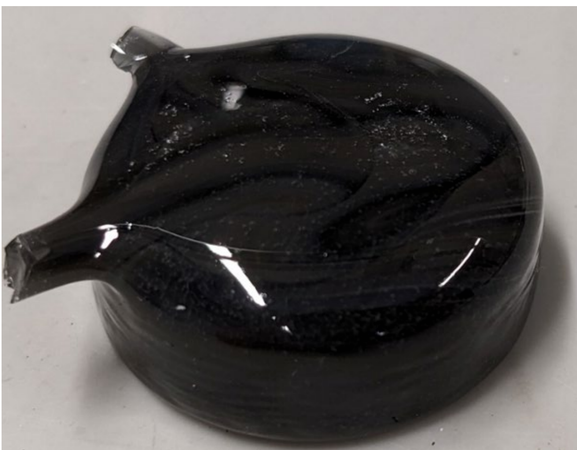
Abbildung 4: 100 g Glasscherben (<math><250 \mu\text{m}</math>) + 2,5 g Kohlenstoff
