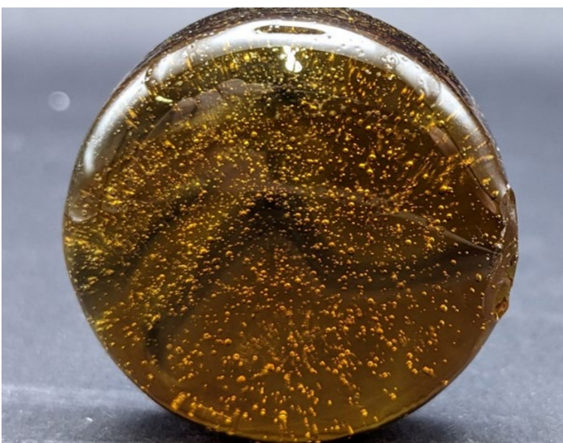
Abbildung 3: 100 g Glasscherben (<math><250 \mu\text{m}</math>) + 26,7 g Ketchup ( \approx 2,5 g Kohlenstoff)
