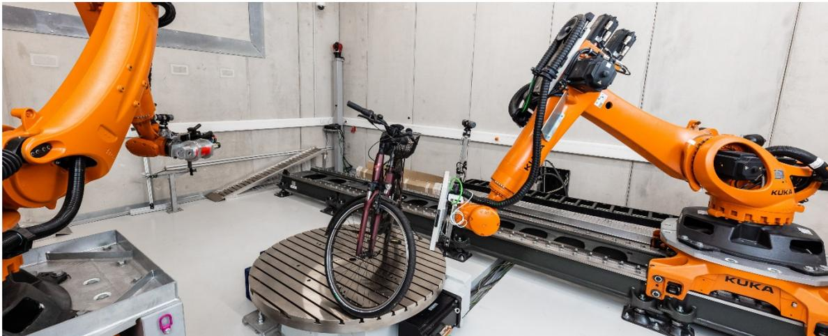
Abbildung 1: Roboter-CT im TC Plattling. Mit der Röntgenquelle (links) und dem Detektor (rechts) können Objekte bis zu einer Auflösung von ca. 125  $\mu\text{m}$  digitalisiert werden.
